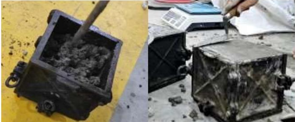
شكل (7) آلية دمك المكعبات الخرسانية وتسويتها وتنعيم سطحها
