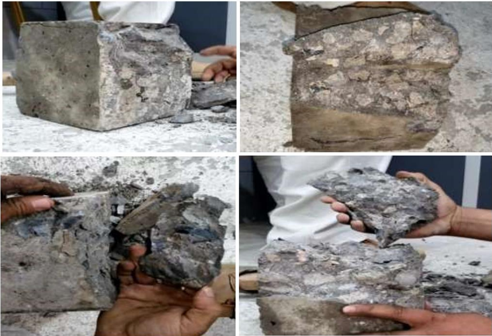
شكل (14) شكل الانهيار في المكعبات الخرسانية ذات نسبة استبدال 100% بعد اخراجها من مكينة الضغط
