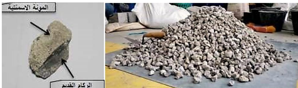
شكل (2-أ) حجم حبيبات الركام الخشن شكل(2-ب) المونة الاسمنتية الملتحمة بسطح الحبيبات
