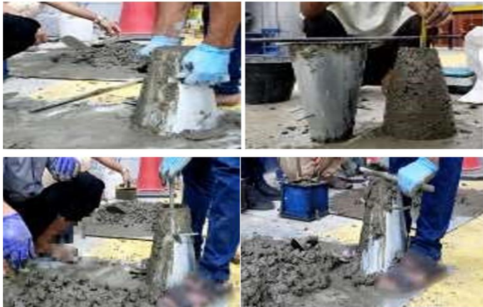
شكل (6) يوضح طريقة اختبار مقدار الهبوط لكل خلطة خرسانية
